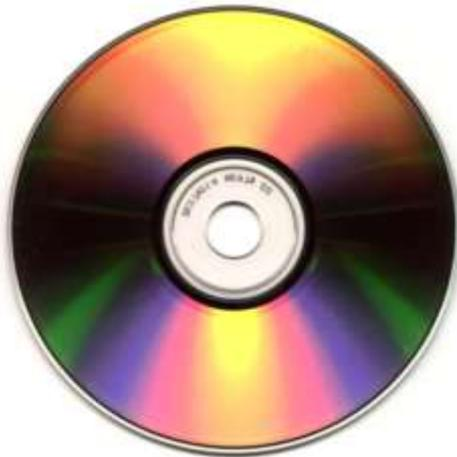
Il laser sviluppa dell'energia e, tramite questo raggio, è possibile scrivere e leggere delle informazioni contenute su un disco sfruttando i differenti gradi di riflettibilità che si possono raggiungere. Il disco è formato da un substrato ricoperto da uno strato di alluminio riflettente. Sopra di esso vi è uno strato di materiale dielettrico trasparente e, infine, vi è uno strato di metallo sottile.
